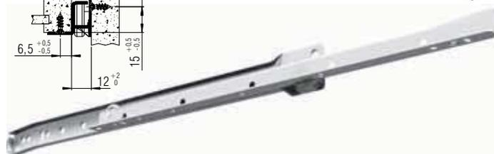
force: **35 kg**, 4 roulements en nylon, montage sous le tiroir, retour automatique, simple extension, la came de réglage permet un réglage du jeu latéral jusqu'à 3mm
