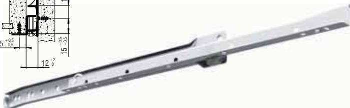
force: **40 kg**, avec 4 galets à billes en acier enrobés de PVC, montage sous le tiroir, retour automatique, simple extension, la came de réglage permet un réglage du jeu latéral jusqu'à 3mm
