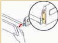
ajuster la façade et "pointer" la position de perçage
