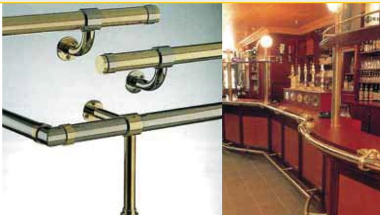
Cet ensemble robuste pour barre repose-pieds ou barre d'appui s'adapte parfaitement à toutes les situations. Vous pouvez ainsi créer en toute liberté, et faire le choix du matériau: laiton ou inox. Les tubes s'emboîtent dans les éléments d'angles, dans les supports et les embouts. Les coupes sont donc toujours invisibles et sont réalisées sur le chantier aux cotes exactes. La fréquence d'écartement des supports est d'environ 800 mm.
