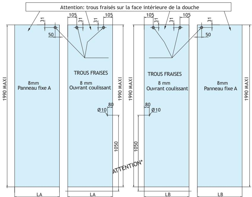
\* Plan valable uniquement pour une porte à droite, pour porte à gauche, inverser le sens des fraisure
