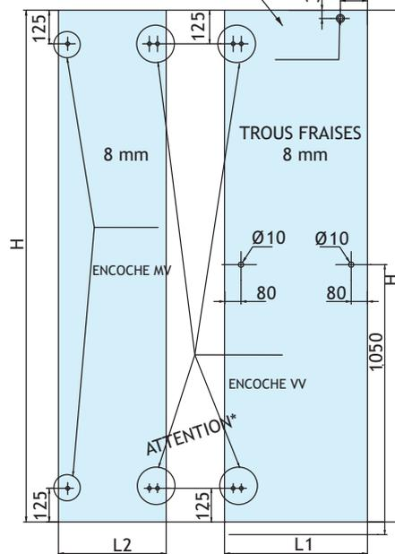
\* Plan valable uniquement pour une porte à droite, pour porte à gauche, inverser le sens des fraisure
