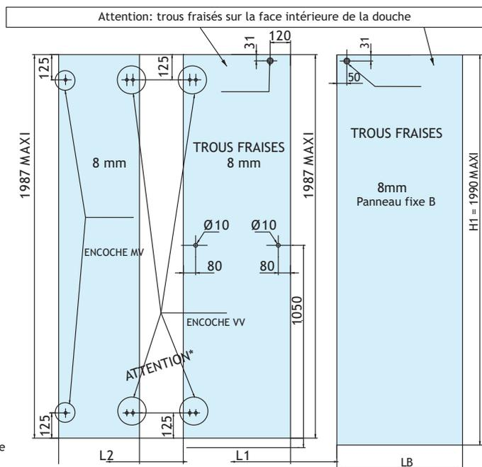
\* Plan valable uniquement pour une porte à droite, pour porte à gauche, inverser le sens des fraisure
