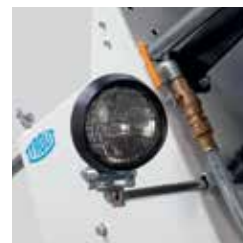
Régulation de l'eau pour un refroidissement d'outil optimal et éclairage utile toujours à portée de main
