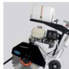
Centre de gravité optimisé par rapport à l'axe de coupe
