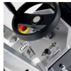
Réglage aisé de la profondeur de coupe et de la vitesse de rotation
