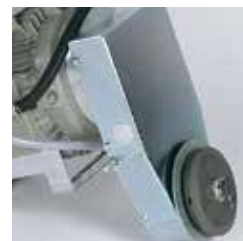
Le réducteur garantit des vitesses de coupe optimales.
