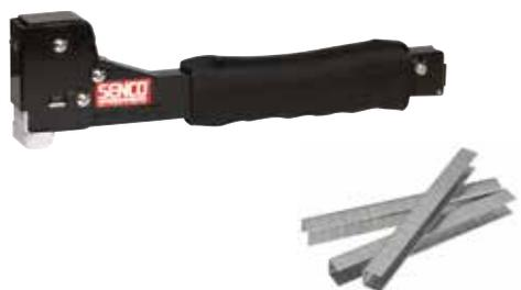
Le marteau agrafeur Senco SHT-F est un appareil manuel à frappe rapide et pratique, lorsque la précision n'est pas demandée, et utilise des agrafes F de 6 à 10 mm. L'agrafe F a un fil plat pour un meilleur appui sur le matériau sans déchirure et convient aux matériaux fragiles.
